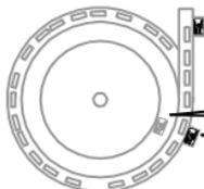
水平安装于振动盘底部或轨道附近。当安装方向与工件运动方向对齐时，振幅检测的灵敏度最高。
