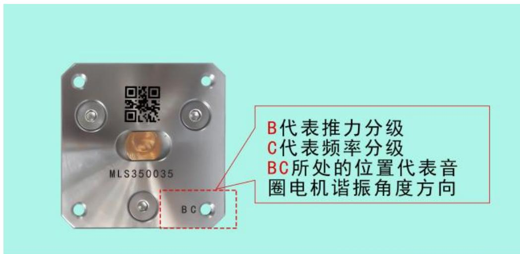
2、音圈电机出厂时已经过谐振角度标定，为达到最佳的运动效果，在安装音圈电机时需注意安装方向，分级标识指向柔振盘中心。
