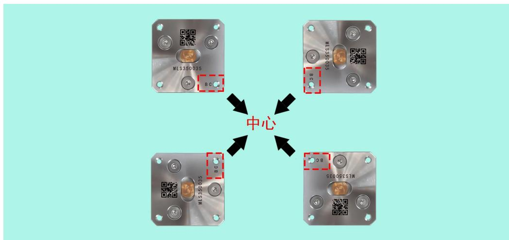
3、安装音圈电机时，为避免音圈电机的下法兰盘的螺丝孔孔径正公差导致偏位锁紧后音圈电机弹簧产生扭曲应
