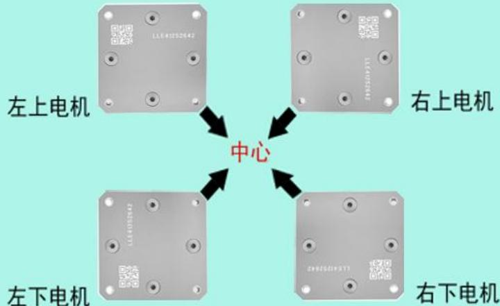
2、安装音圈电机时，为避免音圈电机的下法兰盘的螺丝孔孔径正公差导致偏位锁紧后音圈电机弹簧产生扭曲应力造成振动平台性能劣化，我们建议音圈电机的安装顺序：先锁紧音圈电机上法兰盘与物料盘之间的螺丝，再锁紧音圈电机下法兰盘与底座的固定螺丝，这样可大概率避免安装扭曲应力。
