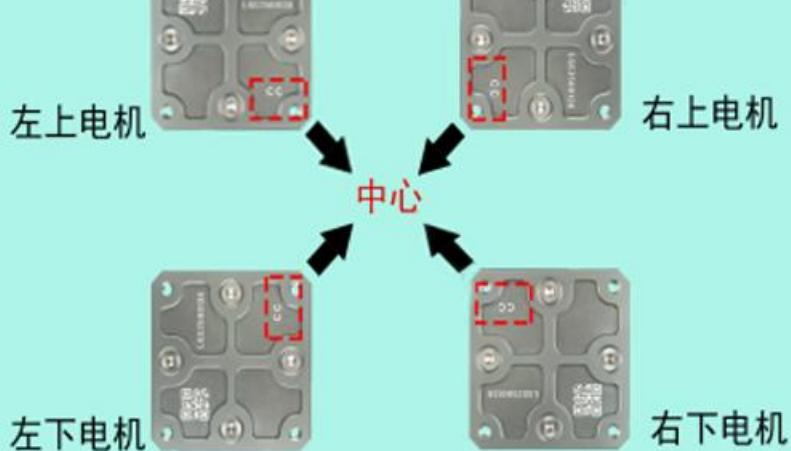
3、安装音圈电机时，为避免音圈电机的下法兰盘的螺丝孔孔径正公差导致偏位锁紧后音圈电机弹簧产生扭曲应力造成振动平台性能劣化，我们建议音圈电机的安装顺序：先锁紧音圈电机上法兰盘与物料盘之间的螺丝，再锁紧音圈电机下法兰盘与底座的固定螺丝，这样可大概率避免安装扭曲应力。
